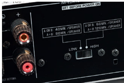
Yamaha stosuje selektory impedancji głównie w sprzęcie wielokanałowym.
