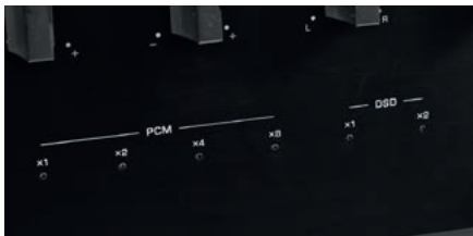
W dolnej części przedniego panelu umieszczono dyskretne, ale praktyczne wskaźniki częstotliwości cyfrowych sygnałów.
