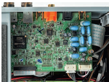
Płytkę cyfrową zawiera przetwornik DAC (ESS Sabre), interfejs wejścia USB, a nawet procesor sygnałowy DSP z algorytmami Dolby Digital i DTS.
